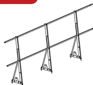
Кровельные ограждения с овальными трубами 40×20 мм / 45×25 мм
